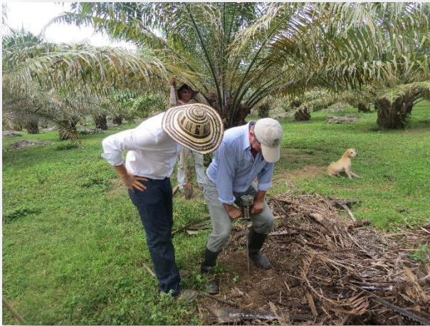
Uso de penetrómetro en campo
