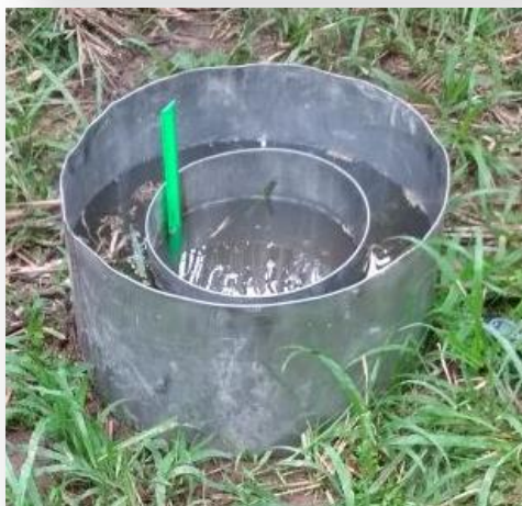
Anillos para medir infiltración
